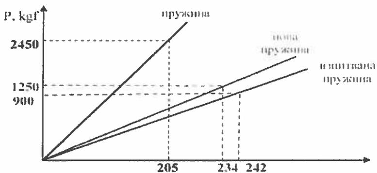
**Забележка:** При натоварване със сила 900 кгс, ако височината на пружината е <234 mm, пружината се бракува.
