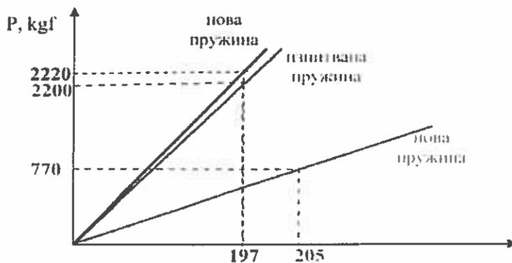
**Забележка:** При натоварване със сила 2200кгс, ако височината на пружината е <197 mm, пружината се бракува.
