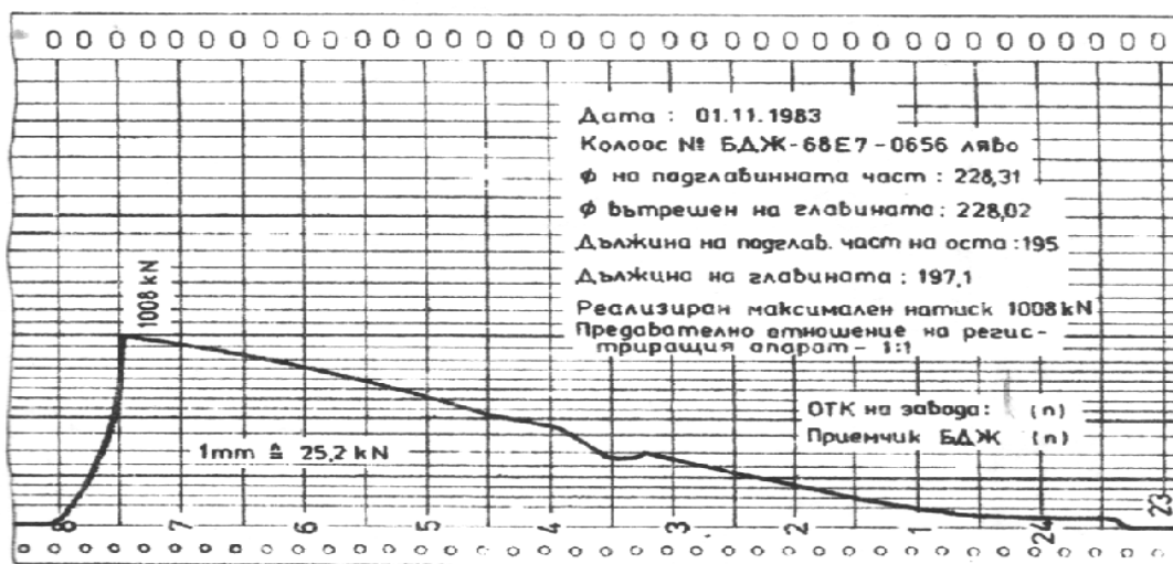
Фиг.13б. ДИАГРАМА НА НАПРЕСОВАНЕ НА ОС В КОЛЕЛО ЗА ЛОКОМОТИВ СЕРИЯ 43 00 (пример)
