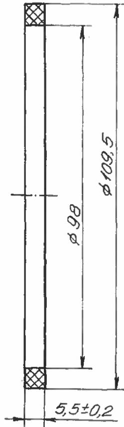
Ненаденените гранични отклонения на размерите  $\pm t_3$ ;  $-t_3$ ;  $\pm t_3/2$  по БДС 14999-80
