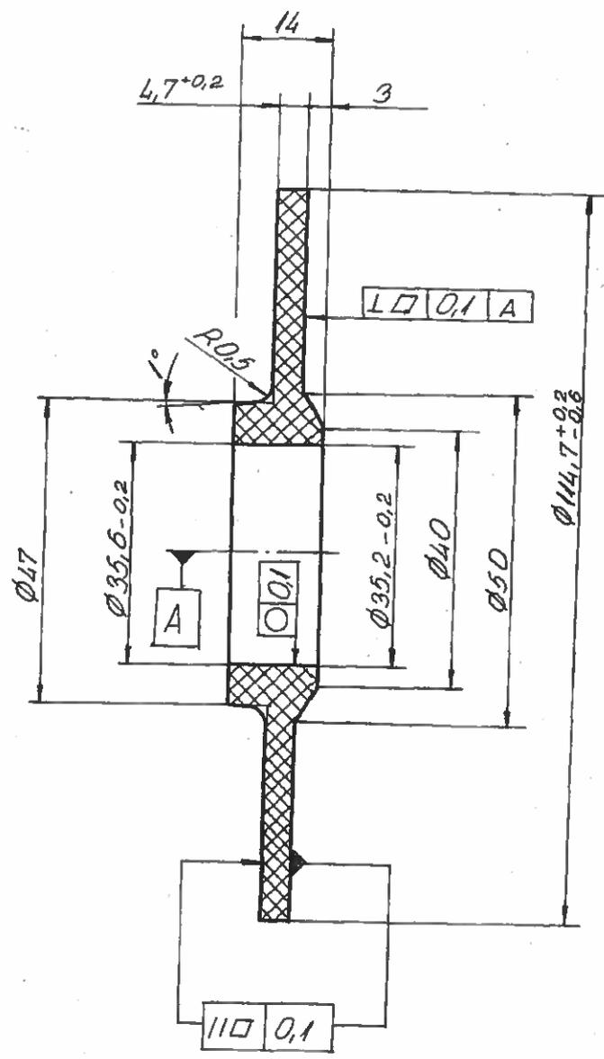
1. Ненанесените гранични отклонения на размерите  $+t_2$ ;  $-t_2$ ;  $\pm t_2/2$  по БДС 14999-80
