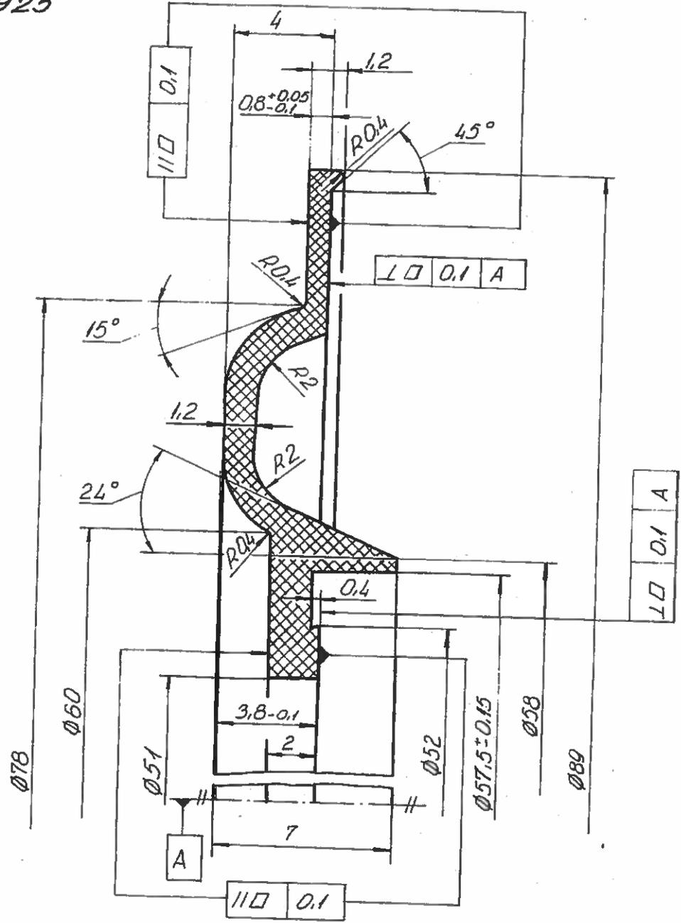
Ненанесените гранични отклонения на размерите  $+t_2$ ;  $-t_2$ ;  $\pm t_2/2$  по БДС 14999-80
