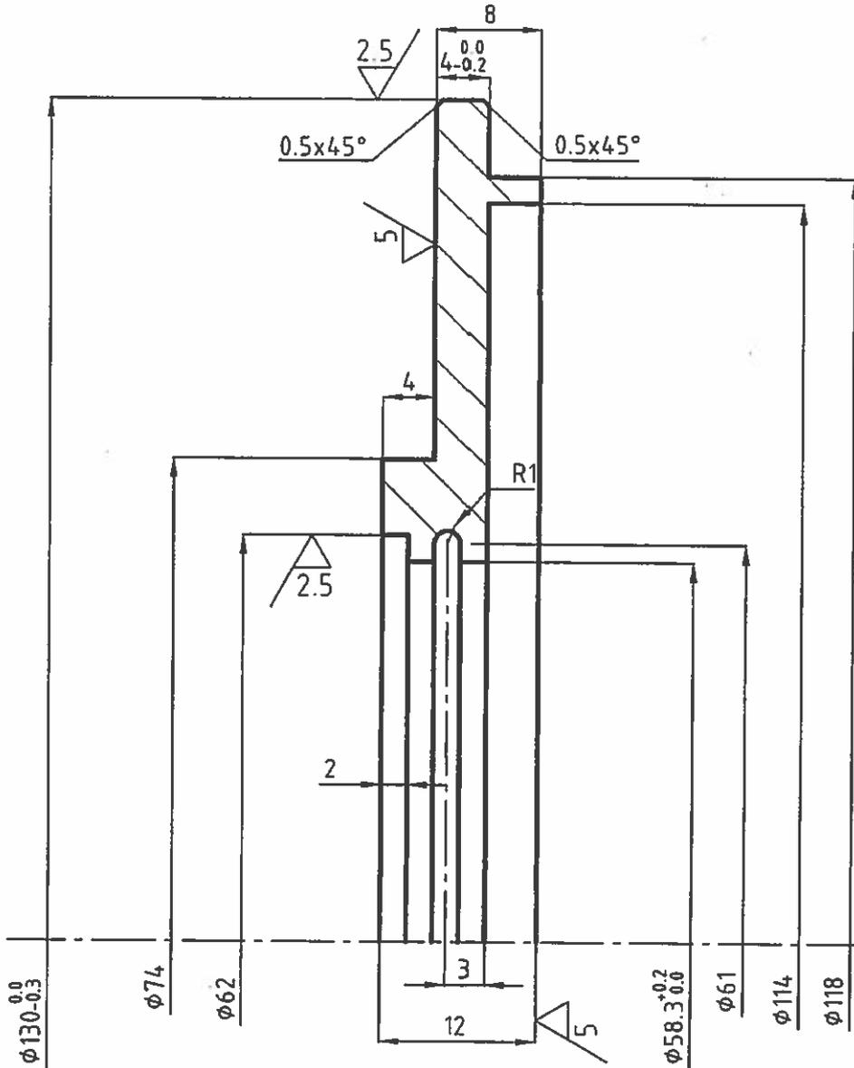
1. Ненанесените гранични отклонения на размерите -  $t_2: \pm \frac{t_2}{2}$  по БДС 14999-80.
