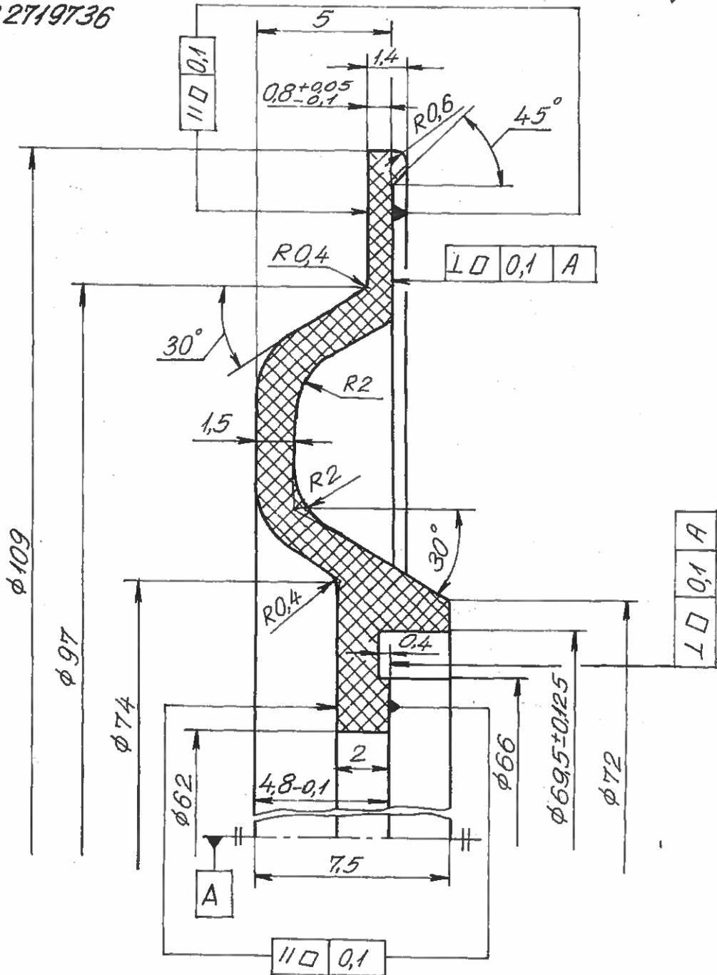
Ненанесените гранични отклонения на размерите  $\pm t_2$ ;  $-t_2$ ;  $\pm t_2/2$  по БДС 14999-80
